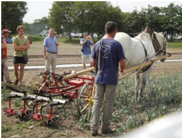
Porte-outils avec un système de sarclage composé d'outils avec doigts Kress
