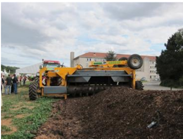
Rendement de 1.100 à 2.000 m 3 /h, utilisé en CUMA
