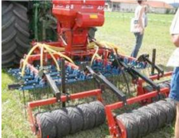
Rouleaux : favorisent le contact du sol avec les semences
