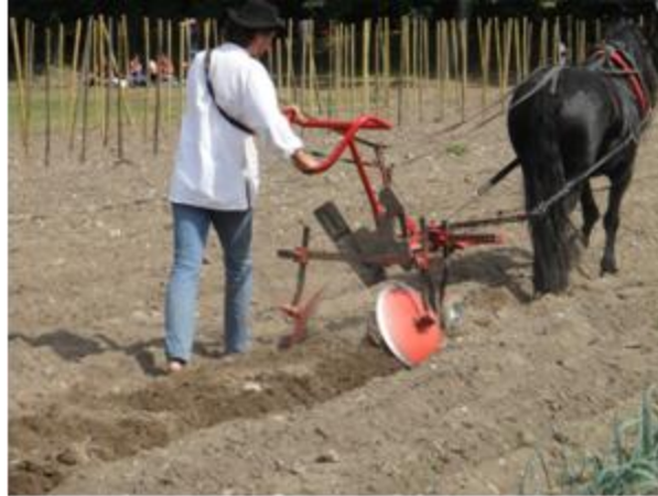
Porte-outils Kassine avec les disques billonneurs
